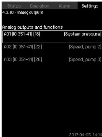
Fig. 88 Analog outputs
