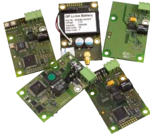
Fig. 38 Grundfos CIM modules
